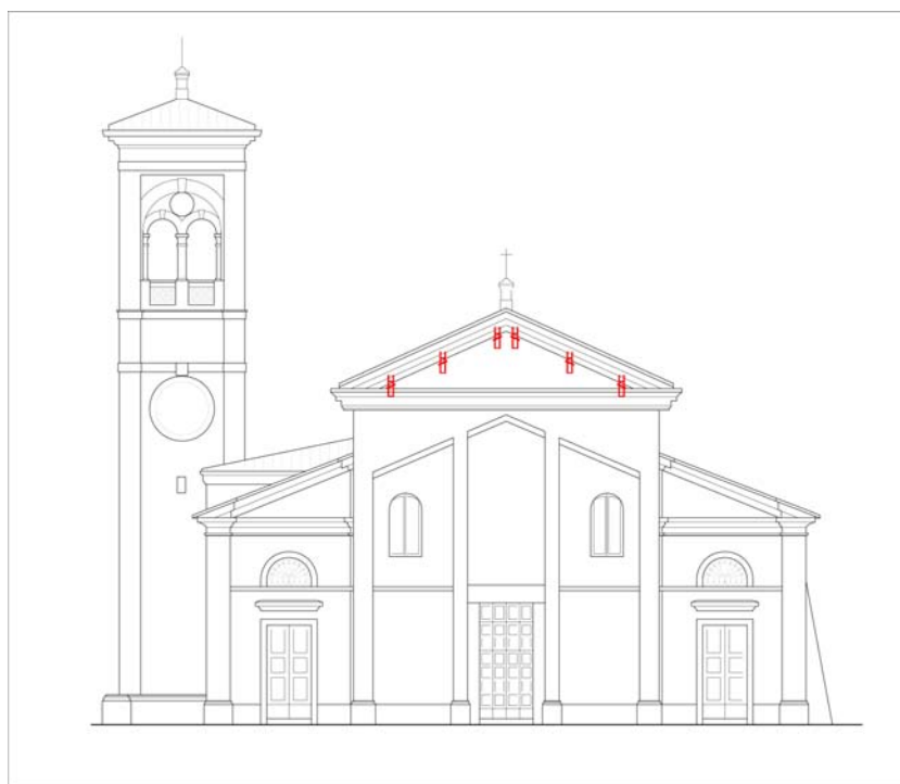
prospetto ovest (facciata) con indicazione dei punti di attacco delle "tasche" metalliche in cui sono alloggiate le testate delle terzere
