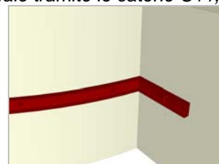
vista tridimensionale dell'attacco della cerchiatura esterna alla parete di chiusura del transetto (si nota il paletto capochiave che ancora la catena C11)
