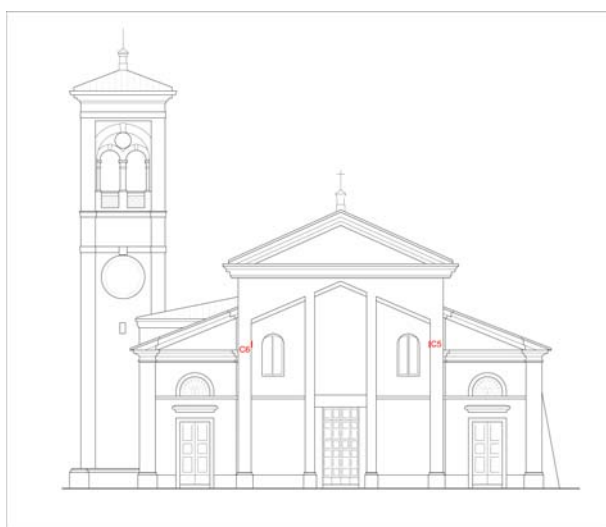
prospetto ovest (facciata) con indicazione della posizione dei paletti capochiave lasciati a vista a lato delle lesene
