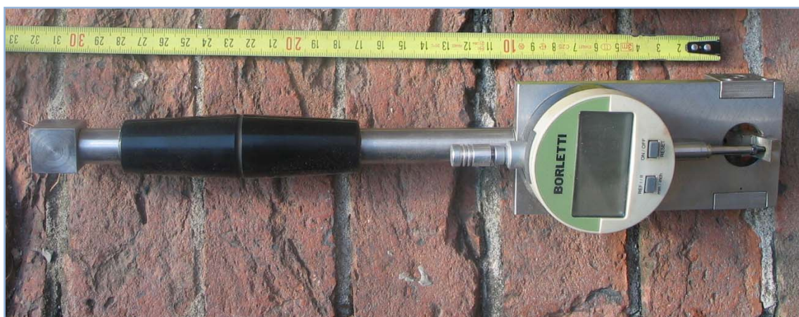
Figura 2.3 – Deformometri digitali con precisione millesimale da 200 e 300 mm.
