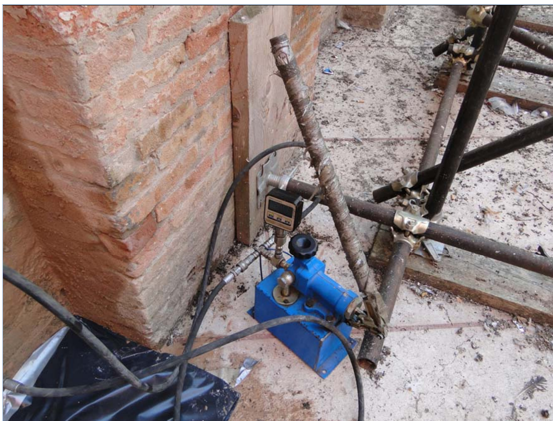
Figura 2.5 – Pompa per martinetti piatti munita di manometro digitale per la lettura della pressione applicata attraverso i martinetti.
