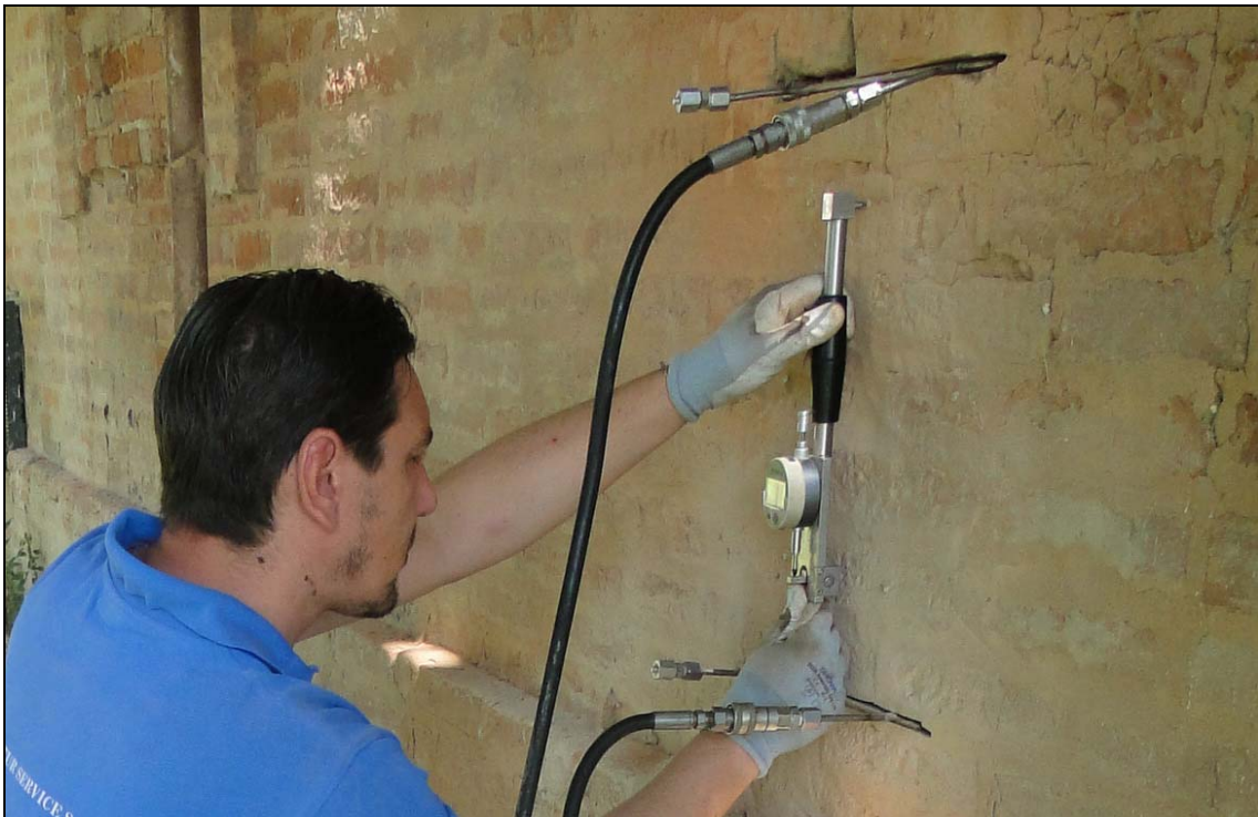
Figura 2.1 – Esecuzione delle letture con il deformometro in corrispondenza delle basi estensimetriche.
